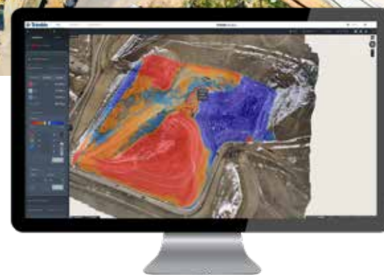
Met de Trimble Stratus software kan men na de drone meting de totale materiaal volumes berekenen van aan te vullen of uitgegraven materiaal en kunnen depots, watergangen, enzovoort eenvoudig en nauwkeurig in kaart gebracht worden.
